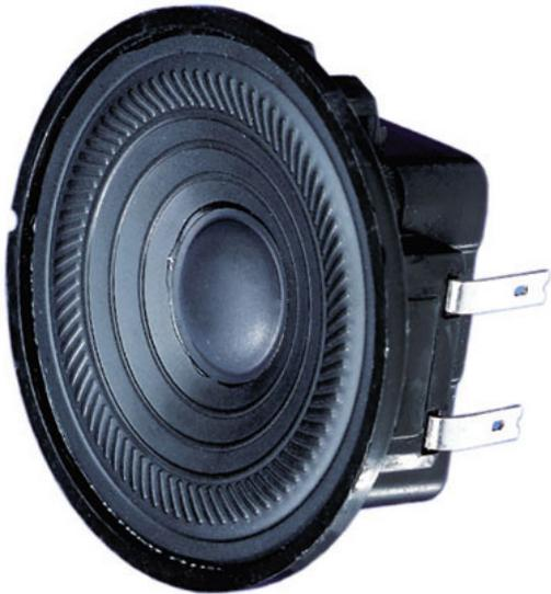
**5 cm (2") Kleinlautsprecher** mit Kunststoff-korb und Kunststoffmembran. Breiter Übertragungsbereich und gute Sprachverständlichkeit. Besonders geeignet für Anwendungen im Außenbereich und unter kritischen Umgebungseinflüssen (z.B. Feuchtigkeit).
